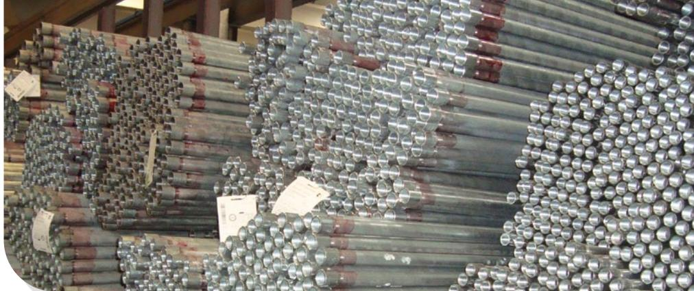
La **zincatura o galvanizzazione** è il processo con cui viene applicato un rivestimento di zinco su un manufatto metallico generalmente di acciaio per proteggerlo dalla corrosione galvanica: esso infatti limita la formazione di micro-celle elettrolitiche ad azione anodica nei bordi di grano.
